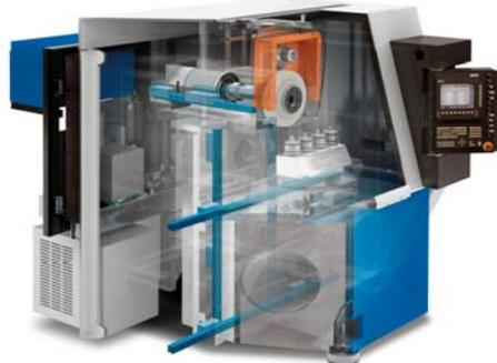
*Schnittansicht der Macro - Tiefschleifmaschine*
