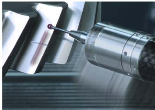
*Die analoge Messung erfolgt per Scannvorgang über die Werkstückoberfläche. Durch seine Eignung, auch analoge Messungen durchführen zu können, werden Bearbeitungsfehler noch in der Werkzeugmaschine erkannt.*
